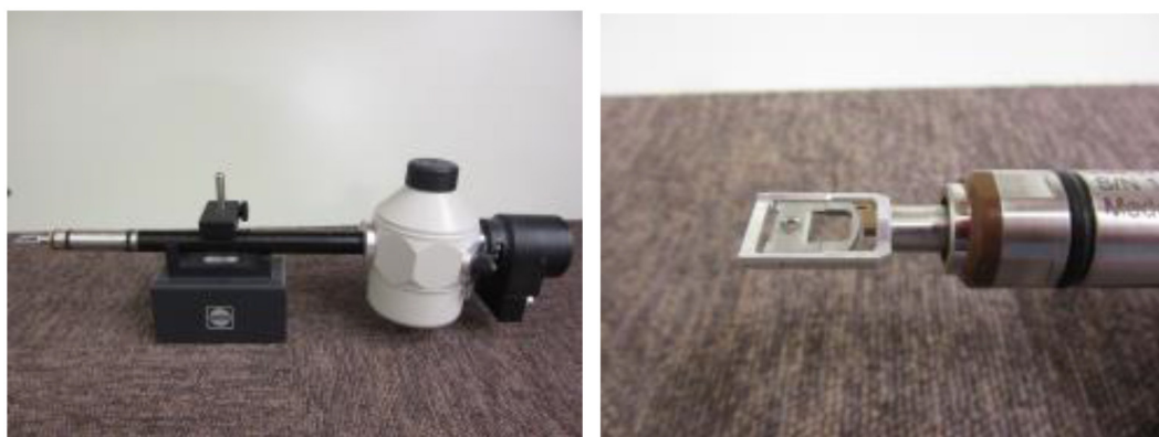
図3 試料冷却ホルダー (GATAN, Model 636) (左) 液体窒素デュアー (右側白色部) 含むホルダー全体, (右) 試料ホルダー先端部
