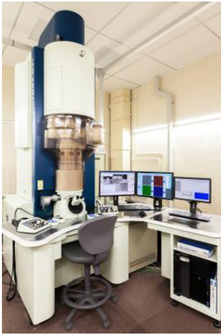
図1 広電圧超高感度原子分解能電子顕微鏡 (JEM-ARM200CF)
