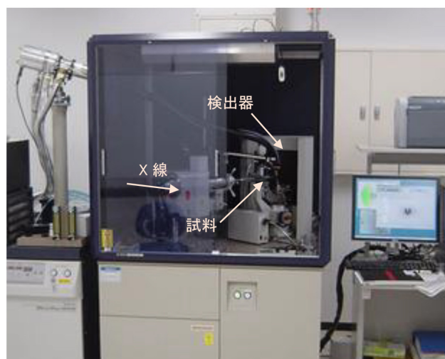
図6 技術支援に用いた単結晶 X 線回折装置
