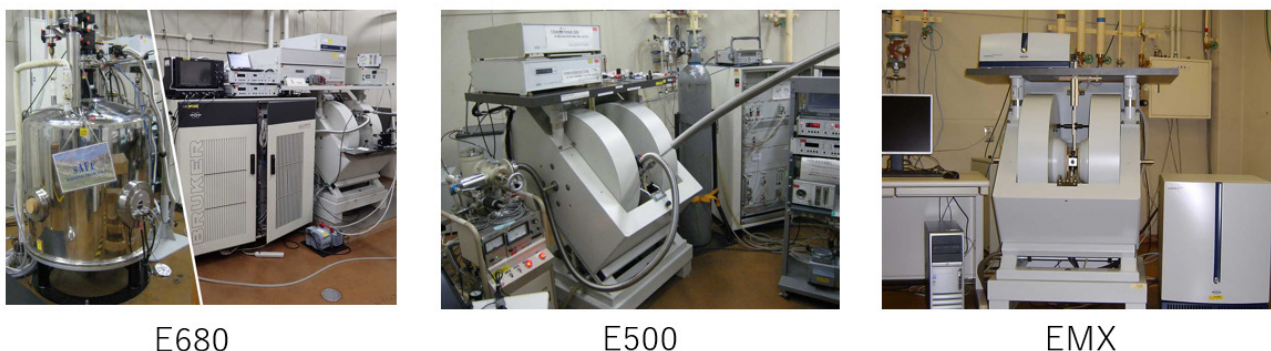
図1 分子研の分子・物質合成PFが公開している電子スピン共鳴装置(3台)
