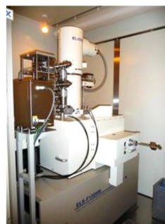
ELS-F130HM 加速電圧：130kV 8インチ角対応 高クロック化、曲面描画機能
