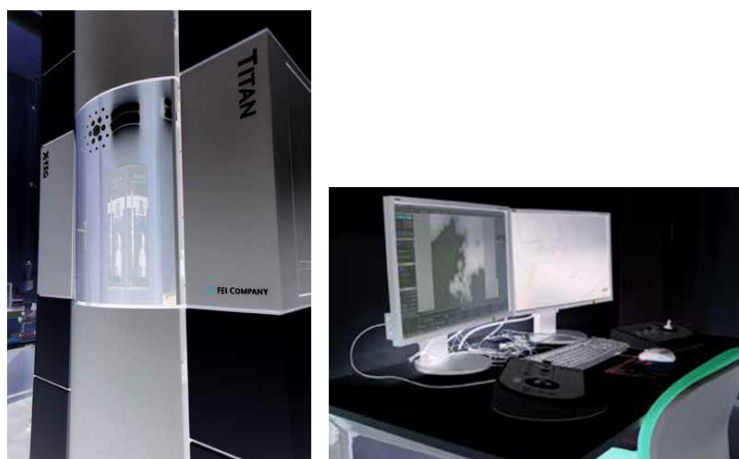
図5 収差補正走査型透過電子顕微鏡：外観（左），操作卓（右）
