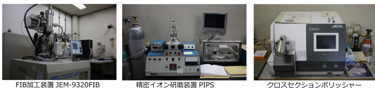
図6 超高压電子顕微鏡研究室に設置された試料作製装置群の装置例
