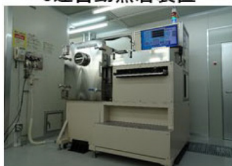
2021年2月中旬導入 6連自動蒸着装置
