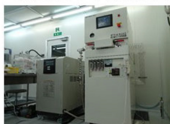
2021年2月上旬導入 赤外線ランプ加熱装置
