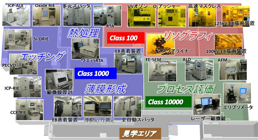
図2 NIMS 微細加工 PF のクリーンルーム (450m 2 ) 内の装置群の配置, クリーン度の Class 別けたエリアに装置が配置されている。
