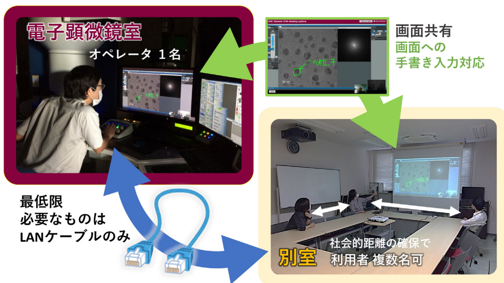
図10 リモート閲覧システム；(左上) 電子顕微鏡室，(右下) 別室でユーザ閲覧
