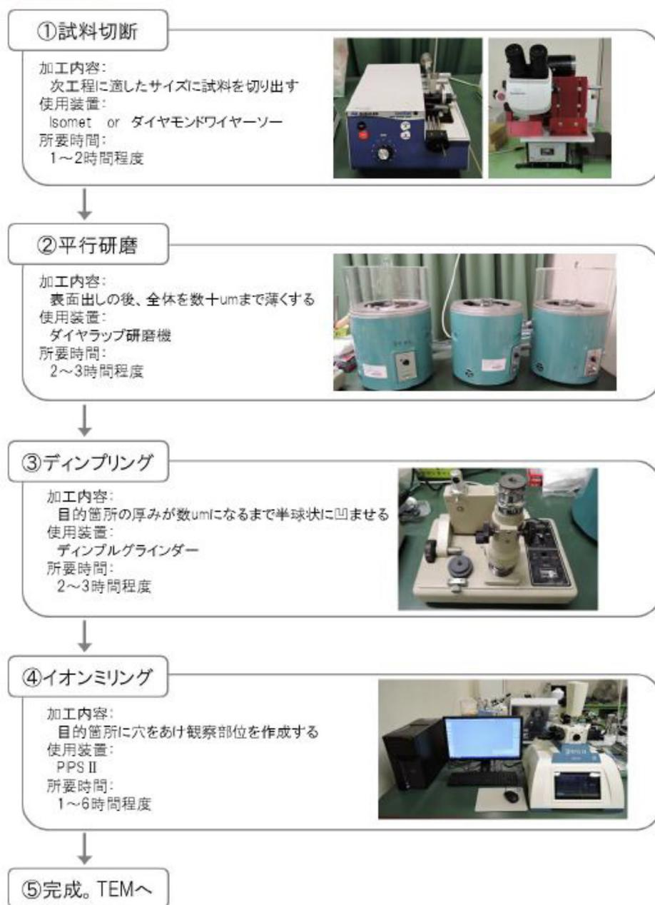
図 11 整備した操作マニュアルの例：TEM 用試料加工
