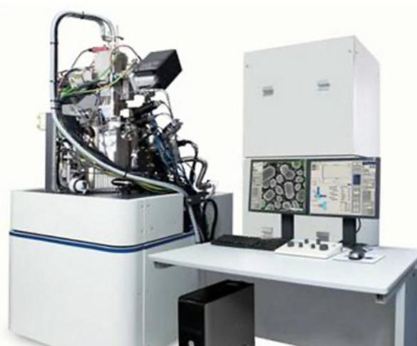
図2 高速加工観察分析(FIB-SEM)装置[3]
