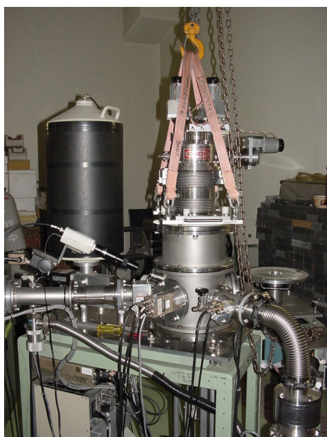
図10 チャネリング測定のためにゴニオメータを装着
