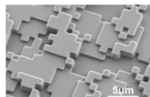
図2 石英基板上に形成したDOEのSEM画像(エッチング後) 深さ: 一段670nm
