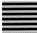
図4 サファイア基板上に形成した偏光素子のSEM画像(現像後) 設計: L/S=350nm/350nm 実測: L/S=340nm/360nm
