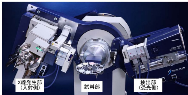
図3 X線回折装置の構成
