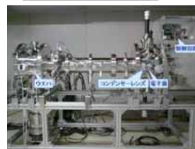
図 4. アクティブマトリクス 100 \times 100 マルチ電子源(上)と、それを用いた 1/100 縮小超並列電子線描画装置のプロトタイプ(下)
