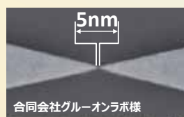
5nmギャップ白金(Pt)電極 (大阪大学)
