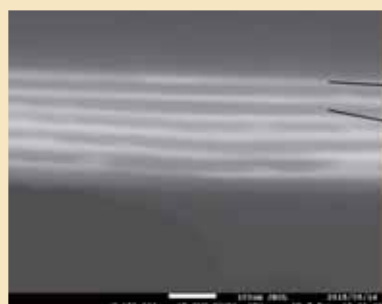
多層膜メタ材料の断面SEM像
