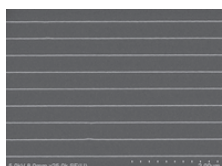
電子線描画装置による11nm 微細パターン
