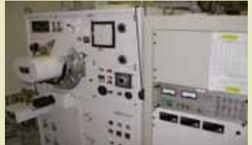
スパッタ(金属、絶縁体)蒸着装置 定通エレクトロニクスQPS-4ES ・平行平板型、ターゲット固有(Ti/Al/Ag/Pd/SiO 2 /Al 2 O 3 /SiN、Au)
